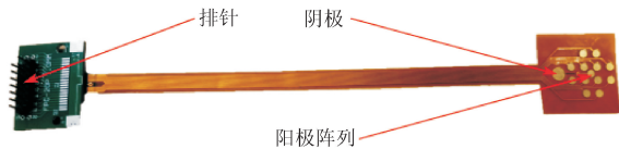
图 12 本文制作的柔性电极阵列 Fig. 12 Flexible electrode arrays fabricated in this paper
